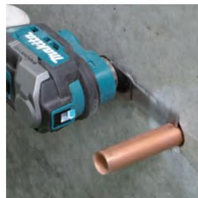
Corte de precisión de tubos de cobre
