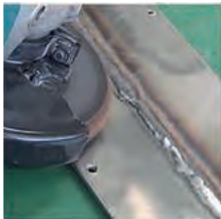
Limpieza en cordones de soldadura
